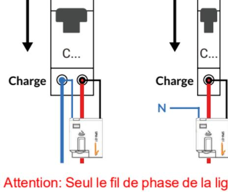
**Attention: Seul le fil de phase de la ligne à mesurer doit passer au travers du capteur.**
