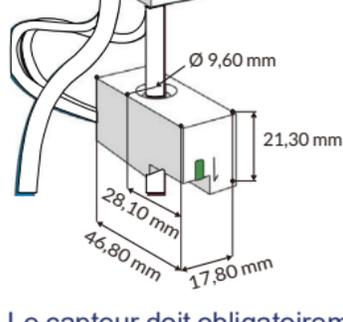
Le capteur doit obligatoirement être installé en aval d'un dispositif de protection.
