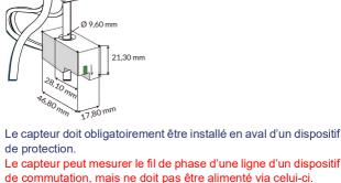
de commutation, mais ne doit pas être alimenté via celui-ci. L'alimentation doit provenir d'une ligne directe d'un disjoncteur.
